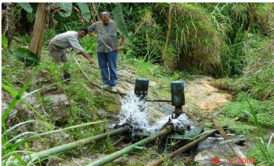
Funcionamiento del ariete hidráulico.
